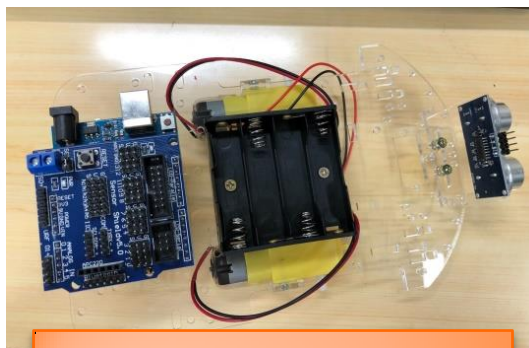
裝Arduino Uno控制板 +感測器擴充版+電池座+超音波感測器
